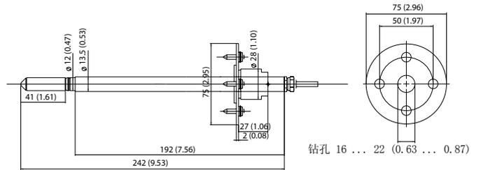
DMT346 散热装置
